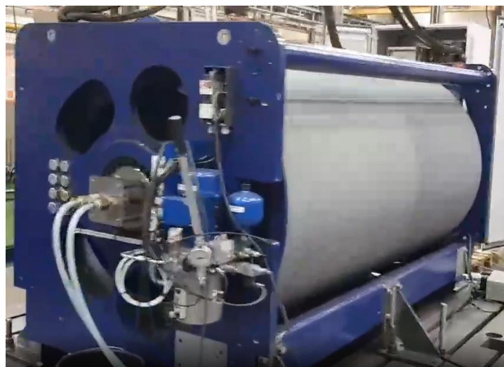
Abbildung 19: Inbetriebnahme von Generatorwinde und Schaltschrank beim Lieferanten
