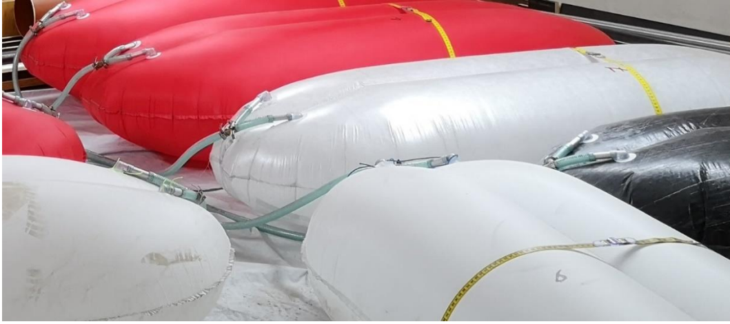
Abbildung 9: Berstkörper im Dauertest
