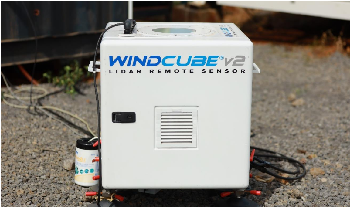
Abbildung 14: An der Pilotanlage verwendetes LiDAR-Gerät
