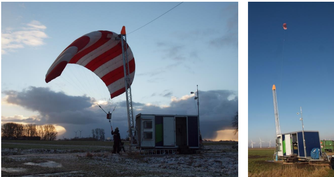
Abbildung 1: Phase1-Anlage in Reinsbüttel (30 kW, 400 m Seillänge, max. Kitegröße 40 m 2 )
